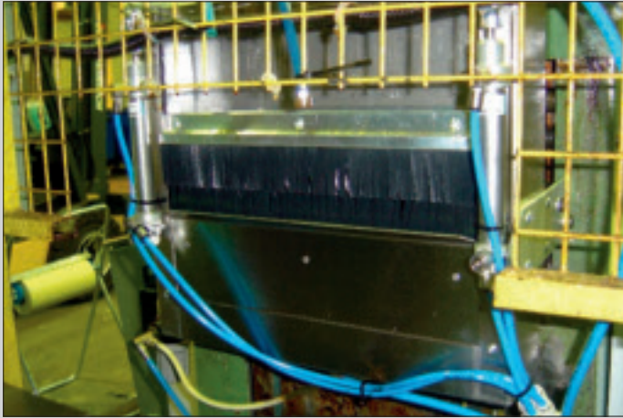
Borst som tätar mot plåten Brushes which seals against the plate Dichtungsbürsten für das Blech
